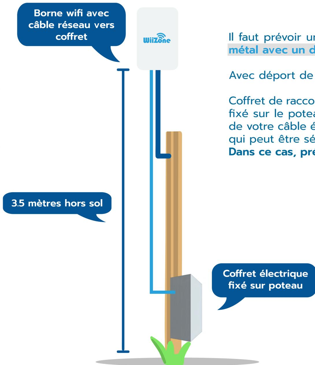
Il faut prévoir un poteau du type **bois traité autoclave** ou en **métal** avec un **diamètre maximal de 50 mm** au sommet.
