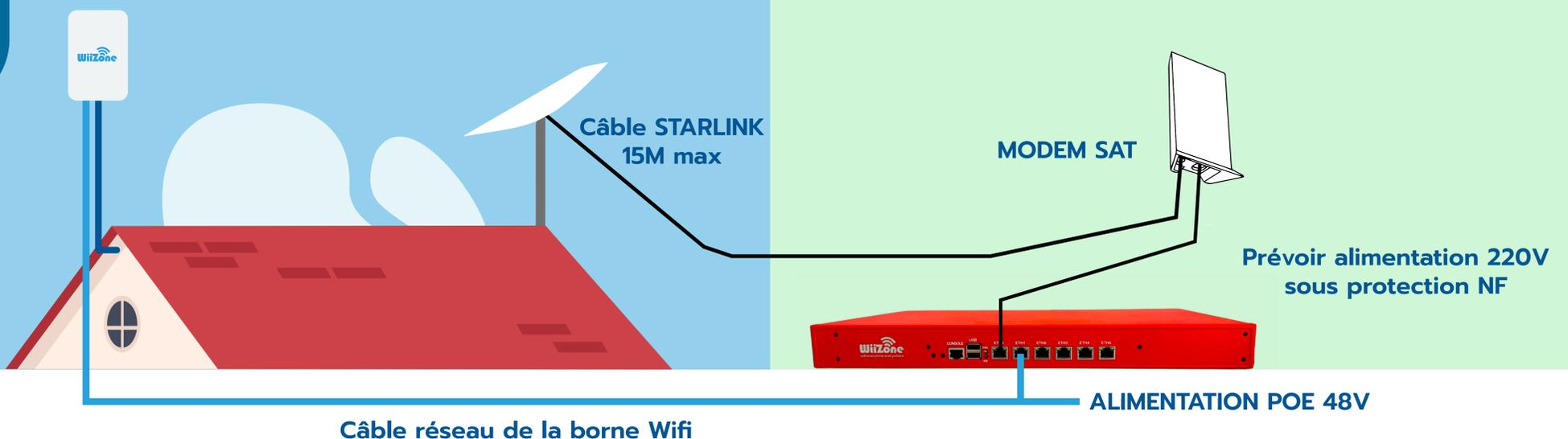
Le raccordement de la parabole doit se faire dans un local ou dans un coffret étanche (si installé à l'extérieur), correctement ventilé car plusieurs équipements seront connectés suivant le schéma ci-dessus.
