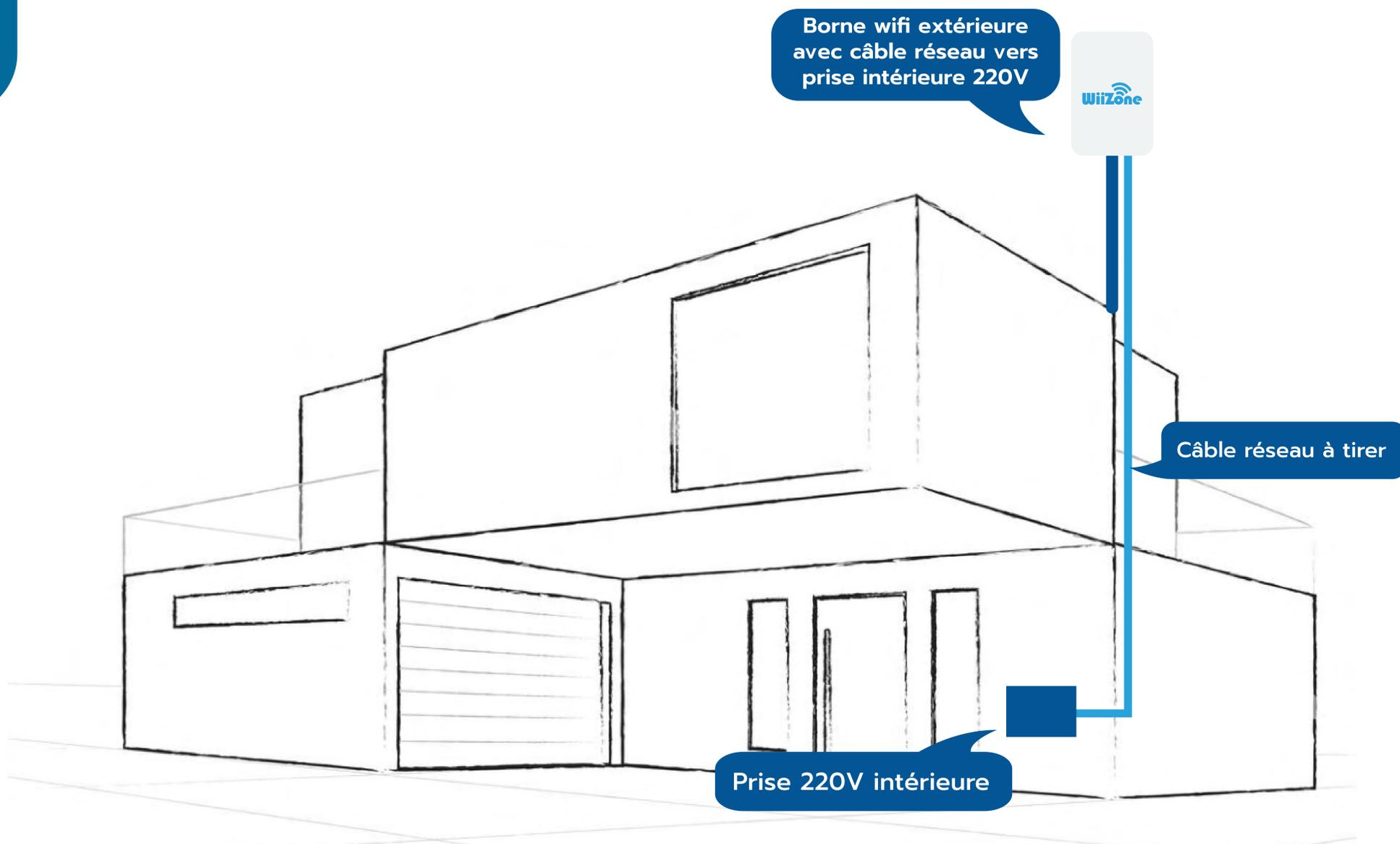
Le mât doit être débordant de **1.5 mètre** minimum (**2 mètres maxi**) du faîtage. Un raccordement par câble réseau entre ce mât et une prise de courant hors d'eau, dans le local, sera nécessaire.
